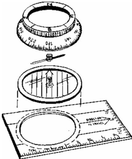
TOP OF COMPASS HOUSING - WITH CARDINAL POINTS ON UPPER RIM, DEGREE DIAL AROUND LOWER RIM.
